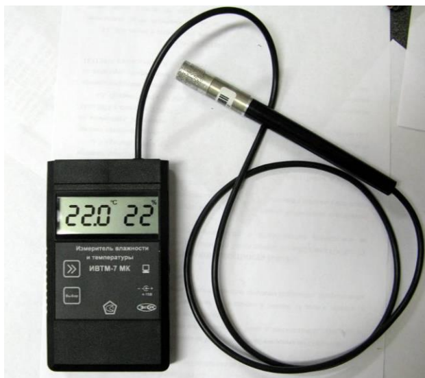
Рисунок 20. Модификация ИВТМ-7 М исполнения ИВТМ-7 М К
