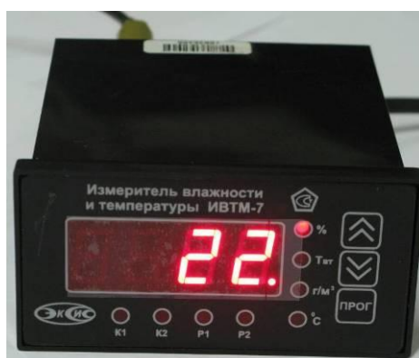
Рисунок 22. Модификация ИВТМ-7 /X исполнения ИВТМ-7 /X –Щ
