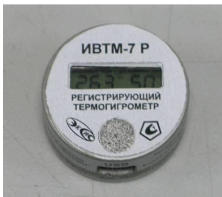
Рисунок 10. Модификация ИВТМ-7 Р исполнения ИВТМ-7 Р-02
