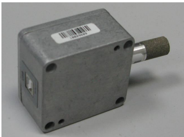
Рисунок 9. Модификация ИВТМ-7 Р исполнения ИВТМ-7 Р-01
