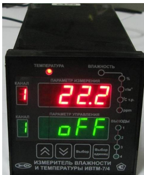
Рисунок 23. Модификация ИВТМ-7 /X исполнения ИВТМ-7 /X-Щ2
