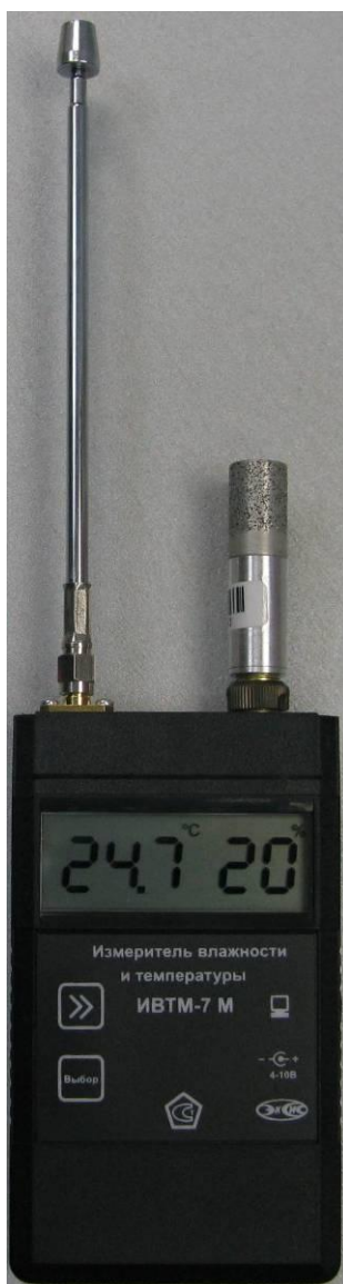
Рисунок 16. Модификация ИВТМ-7 М исполнения ИВТМ-7 М 4
