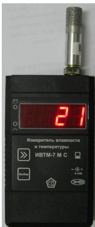
Рисунок 21. Модификация ИВТМ-7 М исполнения ИВТМ-7 М С
