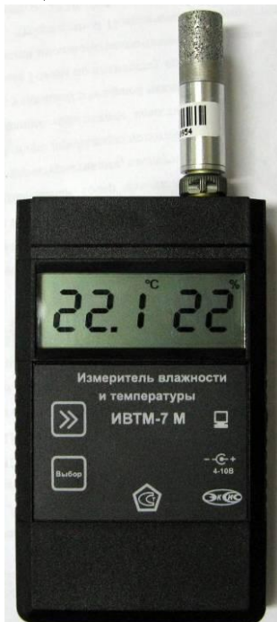
Рисунок 17. Модификация ИВТМ-7 М исполнения ИВТМ-7 М 5
